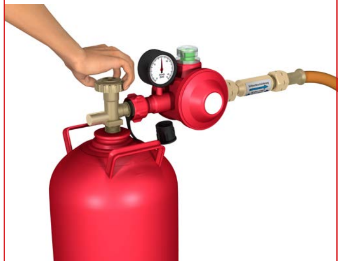
Abb. 30 Zudrehen des Flaschenventils (Flaschenventil = Hauptabsperreinrichtung, Drehrichtung rechts)
