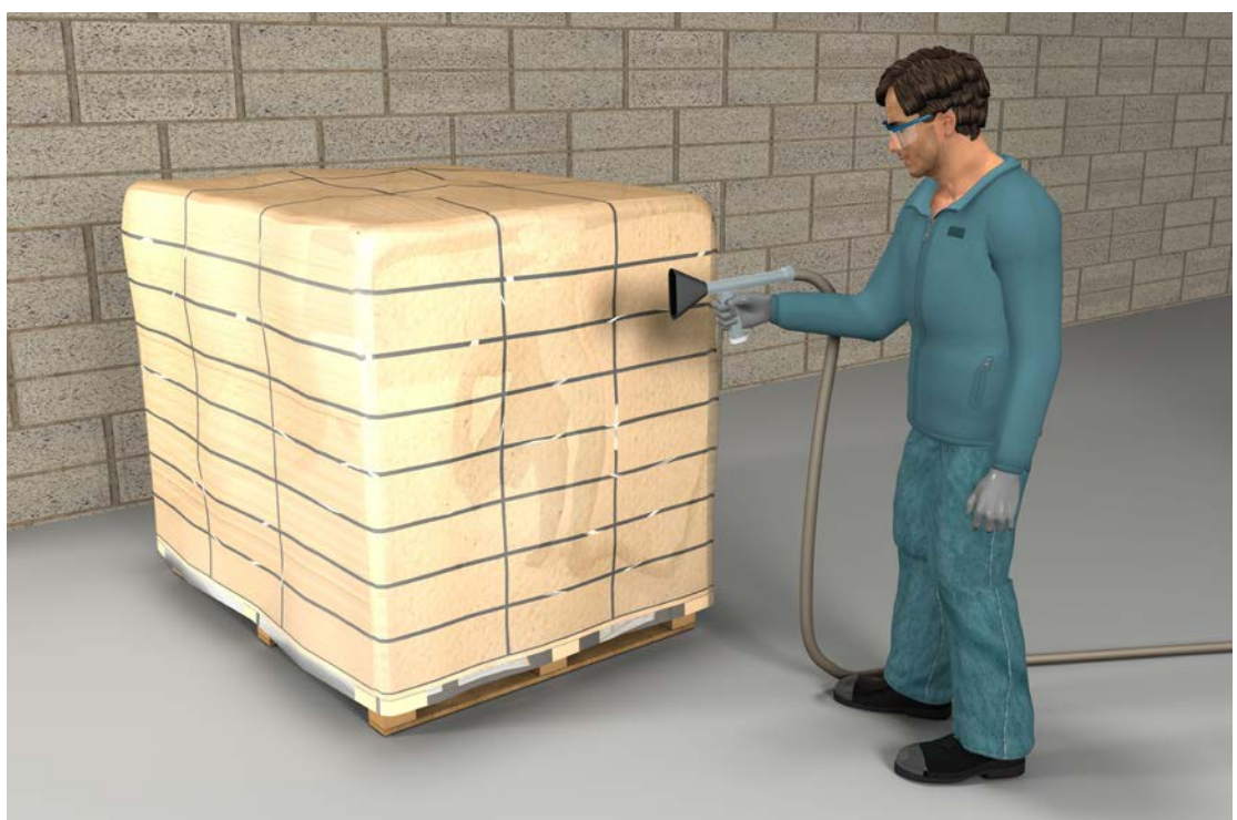
Abb.36 Schrumpfen mittels Handschrumpfgerät
